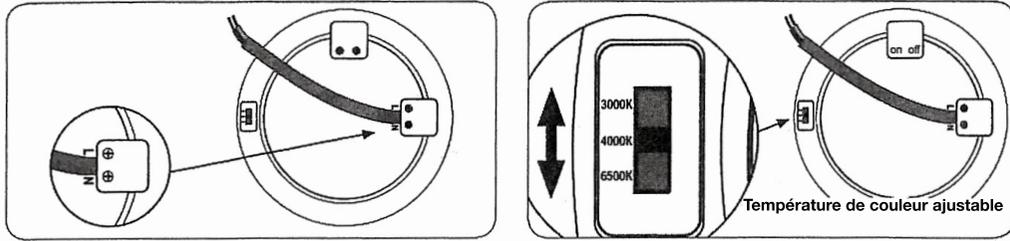
Possibilité d'allumer ou non le détecteur HF (interrupteur situé sous le capot "MICROWAVE")
